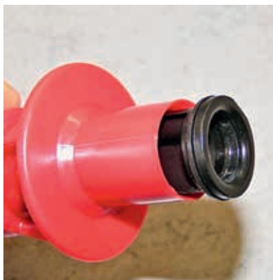
Abbildung 4: Der Schwachpunkt bei den Kanistern ist die Ausfüllkante
