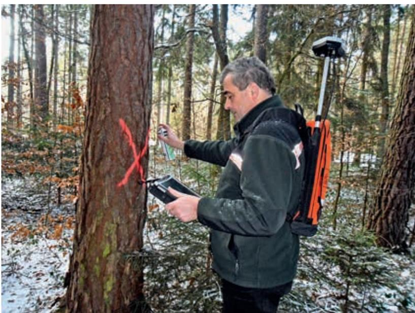
Abb. 1: D-GNSS basierte Überprüfung/ Korrektur der Ist-/ Soll-Erschließung in Altholzbeständen
