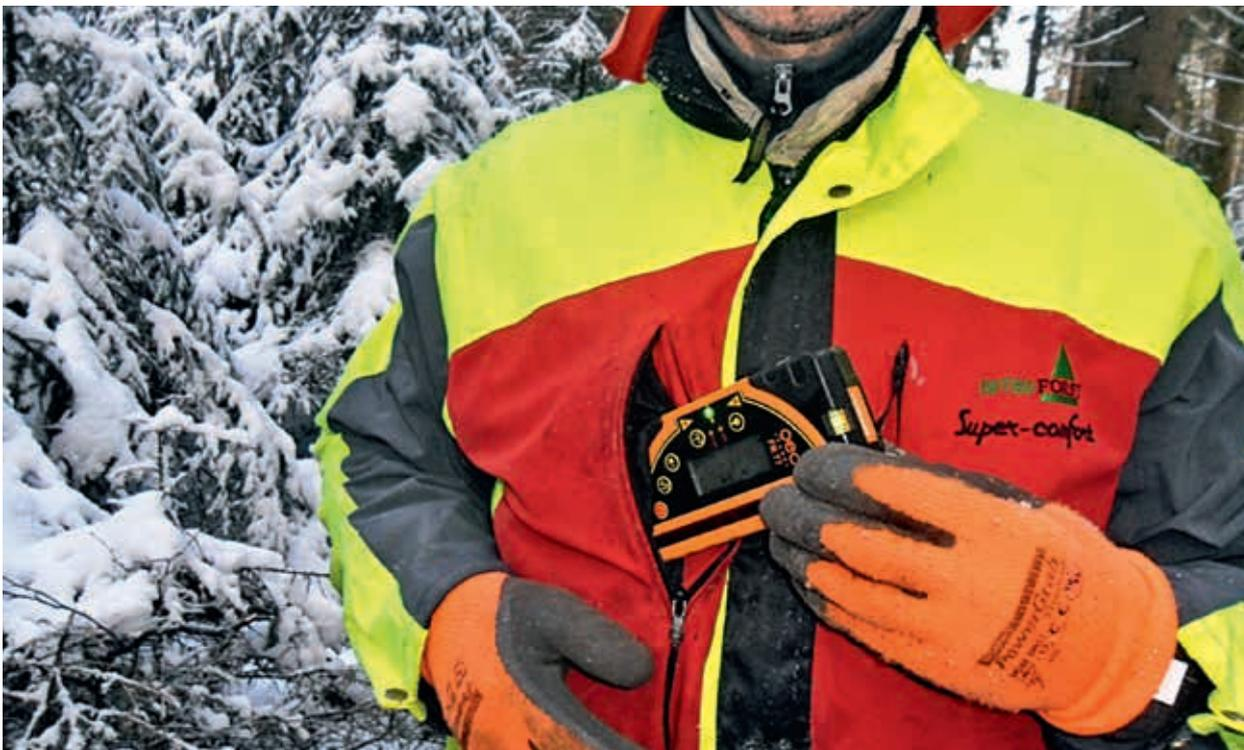
Abb. 4: Akkustisch optischer Laser-Handempfänger
