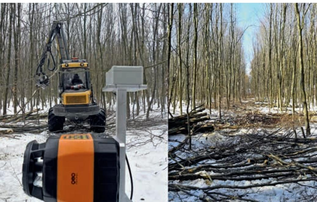
Abb. 11: Links: Fahrzeugnavigation (Ponsse Beaver) mit Richtlaser – Rechts: Ergebnis einer 340 m langen Rückegasse im Laubholz
