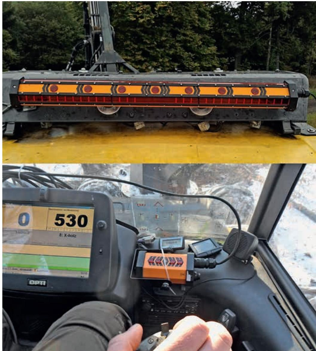
Abb. 8: Oben: Forst-Maschinenempfänger mit Magnettefüßen auf der Fahrerkabine befestigt – Unten: Fernanzeige in der Fahrerkabine
