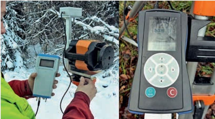
Abb. 3: Einrichtung (Gradzahl) des vertikal angebrachten Rotationslasers. Über eine speziell angefertigte Aufnahmeplatte mit Horizontalfreitrieb ist der Rotationslaser mit dem digitalen neigungskompensierten Kompasssensor fest verbunden (Kompass Fernanzeige: links Prototyp, rechts Serientyp)
