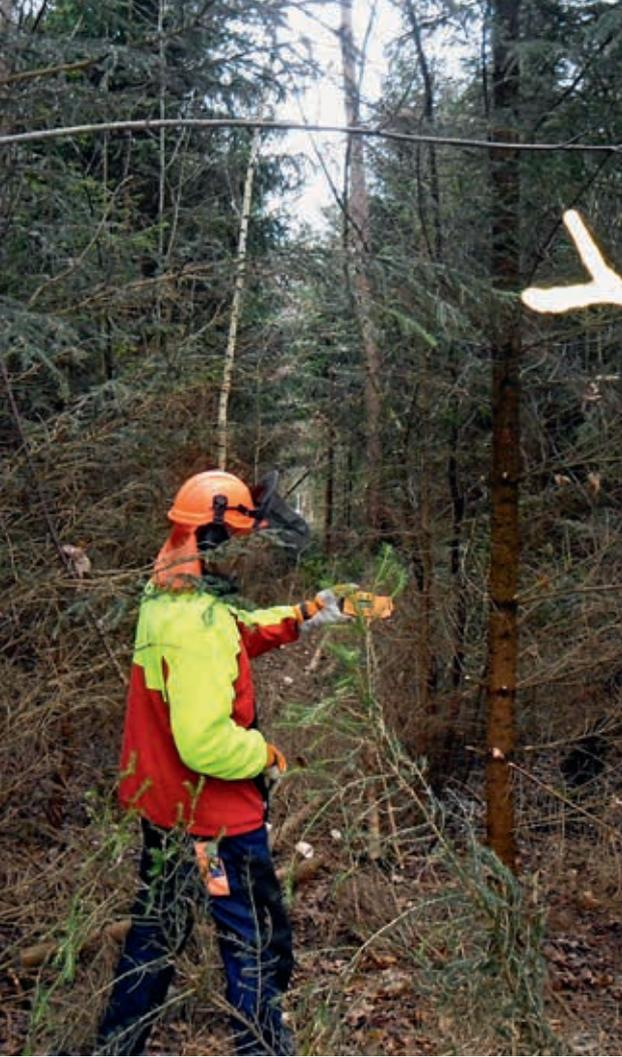
Abb. 5: Einsatz des Handempfängers: Richtlasergestütztes Einlegen von Zugangslinien (Ergebnis: hier Länge von 440 m)
