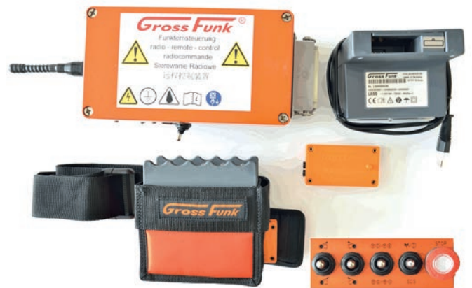
Funkfernsteuerung Bauart Gross Funk (Foto: G. Weise)
