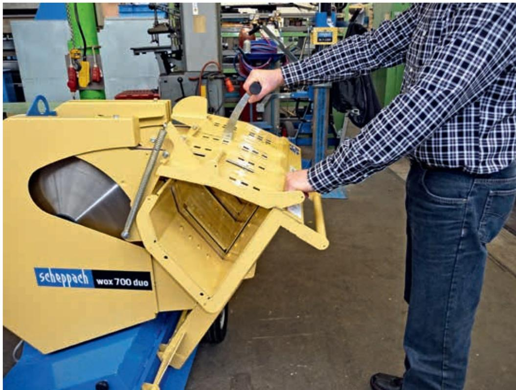
Abbildung 3: Wipp-Kreissäge mit zusätzlicher Klappe über dem Sägekanal gegen das Eingreifen (Foto: Scheppach)
