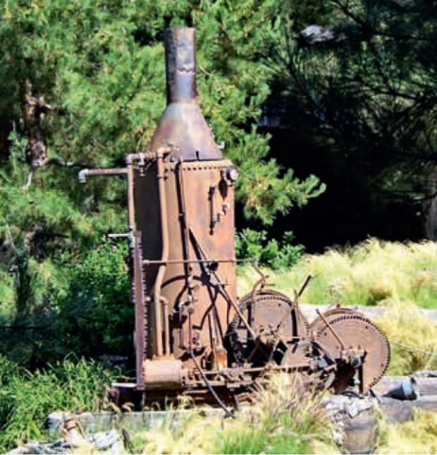
Abbildung 9: Dampftriebene Schlittenwinde (Steam Donkey) für forstliche Rücke- und Verladearbeiten; Wikipedia GNU public domain
