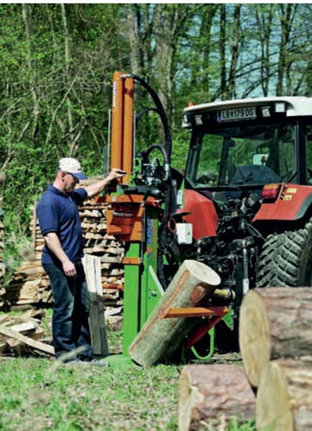
Abbildung 8: Eine hydraulische Stammhebevorrichtung bringt das Stammholz an die richtige Spaltposition und schont somit den Rücken des Bedieners. Das Heben des Stammes erfolgt unabhängig vom Spaltzyklus mittels eigenem Hydraulikventil. (Foto: Posch)
