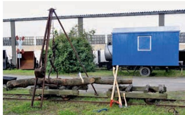
Abbildung 14: Einfaches Dreibeingestell mit Hubwinde, geeignet etwa zur Beladung von Feldbahntrucks mit Schäften und Abschnitten; Hilfsmittel zur manuellen Be- und Entladung (Sappie, Pack- und Wendehaken) (Foto Przygoda)
