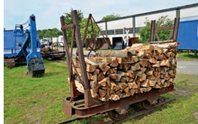
Abbildung 13: Flachwagen mit typischen Endrungen mit Scheitholz beladen im Frankfurter Feldbahnmuseum
