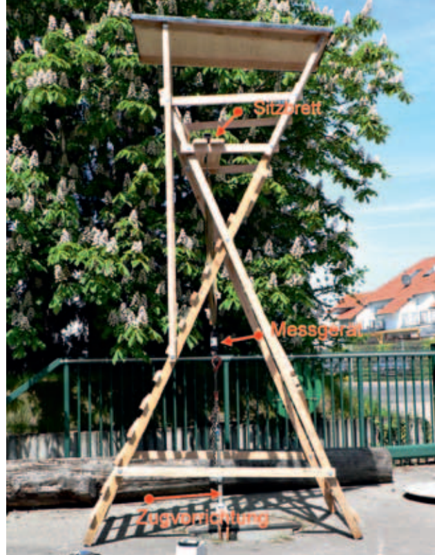
Abb. 2: Prüfung der Festigkeit am Sitzbrett
