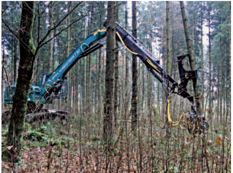
Der Raupenharvester Königstiger T30 Gigant von IMPEX mit Baumhaltezange kann die Bäume stehend zur Rückegasse heben
