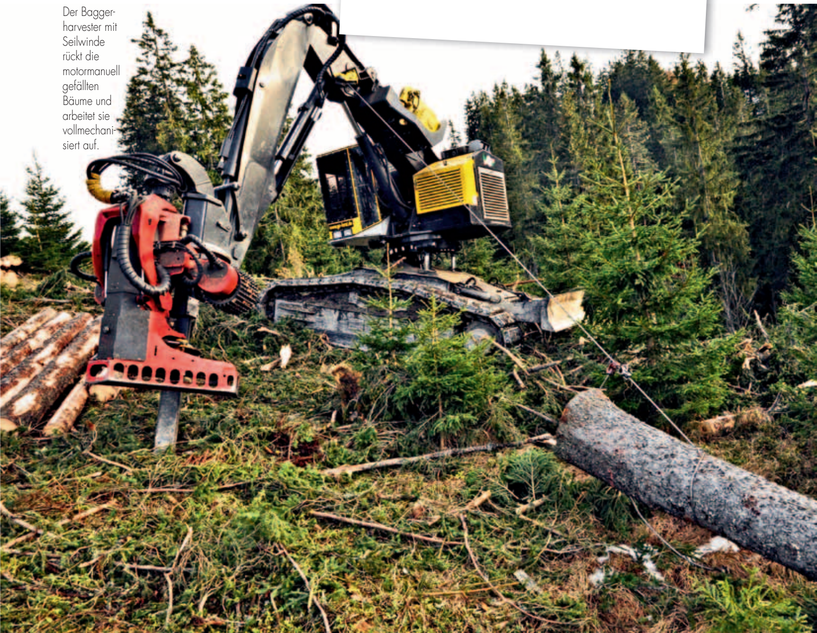
Nach dem Rücken mit Baggerseilkran erfolgt die motormanuelle Aufarbeitung
