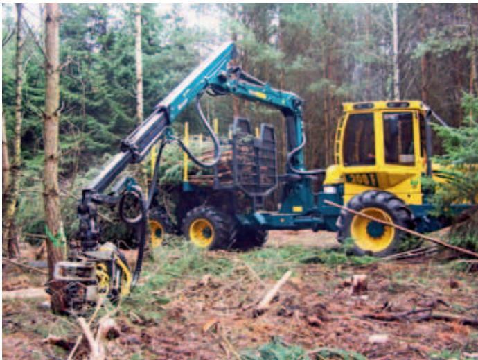
Energieholzharwarder auf Basis des Forwarders HSM 208 F
