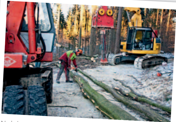
Nach dem Rücken mit Baggerseilkran erfolgt die motormanuelle Aufarbeitung
