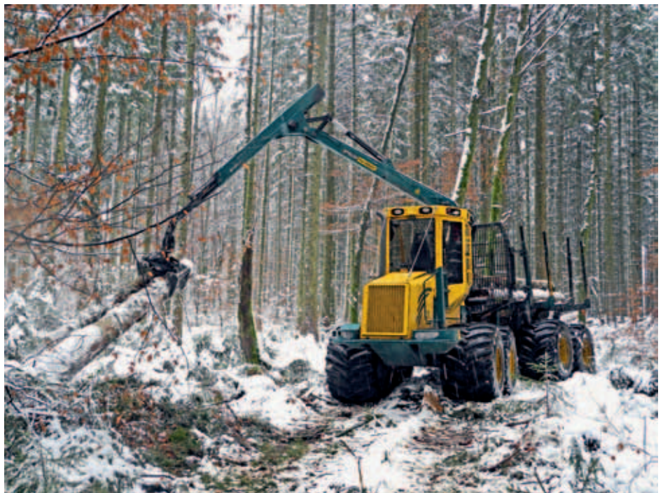
Tragschlepper HSM 208F mit 940 mm breiten Reifen.
