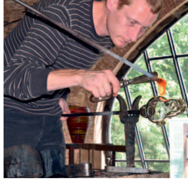
Abbildung 4: Glasmacher beim freien Ausformen eines Glasobjekts (Glashütte Gernheim)
