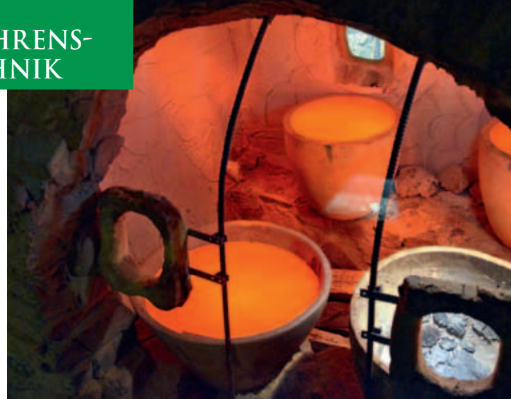
Abbildung 13: Rekonstruktion des Inneren eines mittelalterlichen Glasofens (Hessenpark, Neu Anspach)
