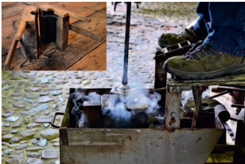
Abbildung 20: Blasen eines Trinkglases in einer Holzform; kleines Bild geöffnete Form (Glashütte Gernheim)
