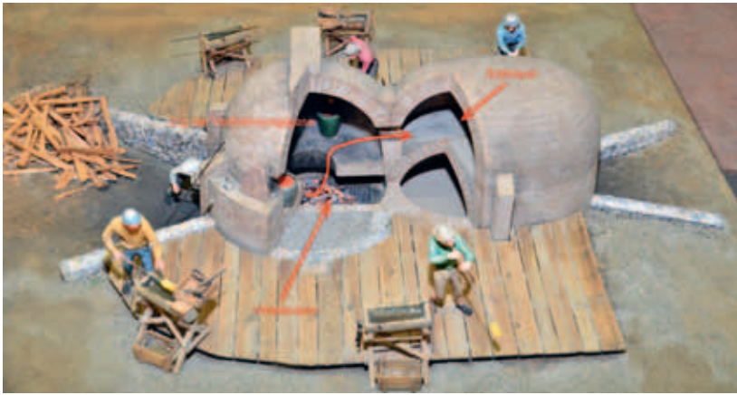
Abbildung 15: Modell eines holzbefeuerten Glasmacherofens mit Rostfeuerung aus dem 17. Jahrhundert mit Arbeits- und Kühlbereich und Arbeitsplattform (Deutsches Museum, München)
