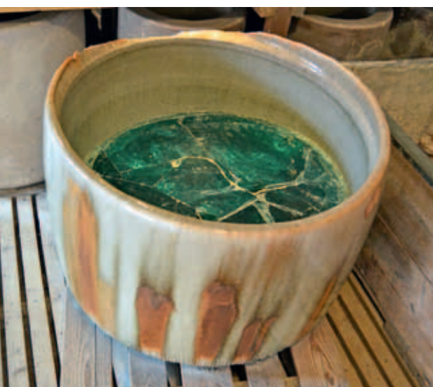
Abbildung 14: Keramischer Glasmachertiegel oder Hafen zum Schmelzen von Glas in Glasmacheröfen mit erstarrter Glasmasse (Glashütte Gernheim)
