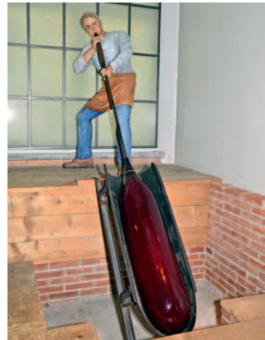
Abbildung 23: Glasmacher beim Anfertigen eines Zylinders, der etwa auch zu Flachglas umgearbeitet werden kann (Deutsches Museum München)
