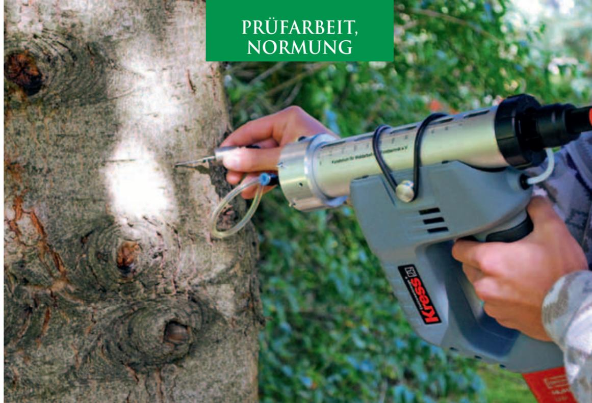
Das vom KWF entwickelte und als Prototyp gebaute Akku-Injektionsgerät
