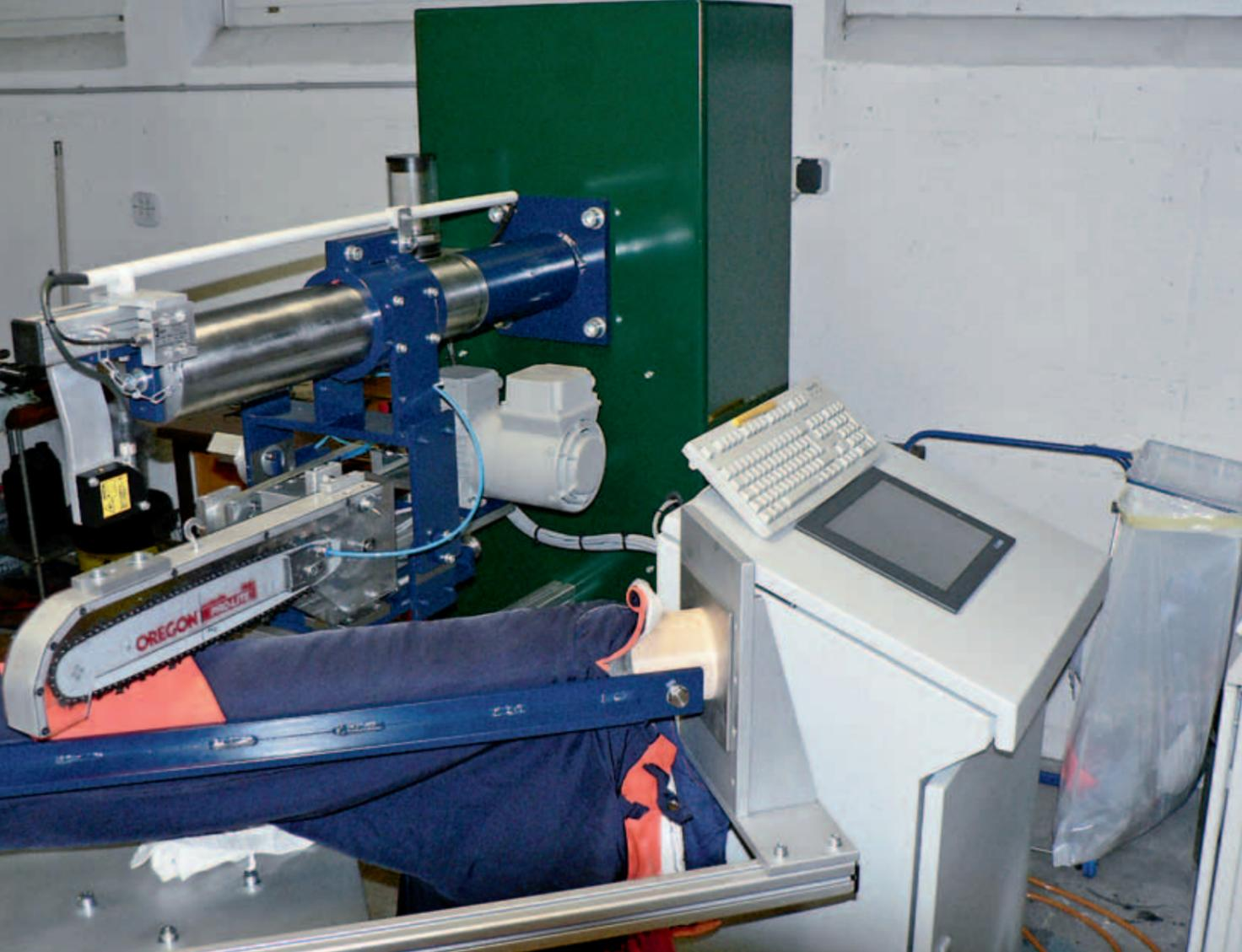
Abb. 1: Schnittschutzprüfstand, mit dem im KWF Groß-Umstadt die Schutzbekleidung geprüft wird.
