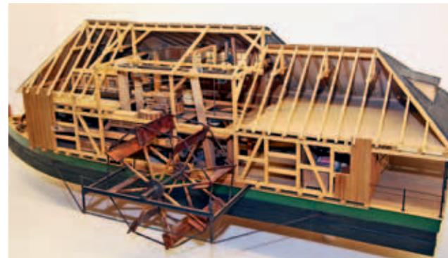
Abb. 2: Modell einer Schiffsmühle mit unterschlächtigem Wasserrad im Deutschen Museum in München
