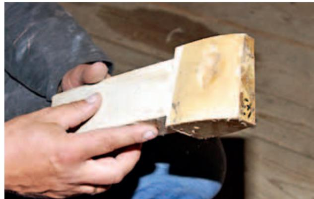
Abb. 11: Einzelner Kamm eines Kammrades
