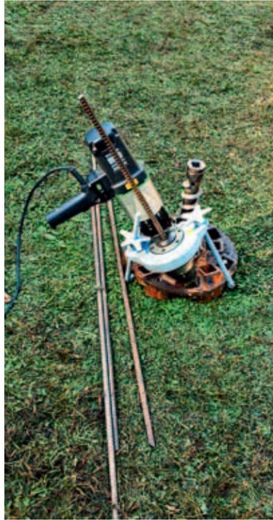
Abb. 4: Der „Spinnanker“ – ein betonloser Bodenanker der Fa. Oberhofer als Ersatz für einen „Toten Mann“
