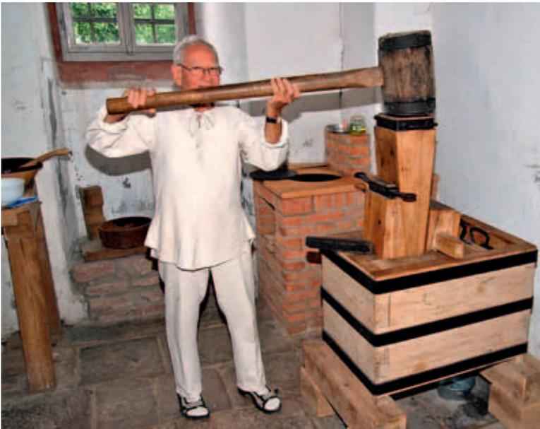
Abb. 17: Keilpresse in der Klostermühle in Seligenstadt zum Auspressen der zerkleinerten Ölsaaten; links neben dem Treibkeil erkennt man den Keil zum Herausschlagen der verkeilten Anordnung.
