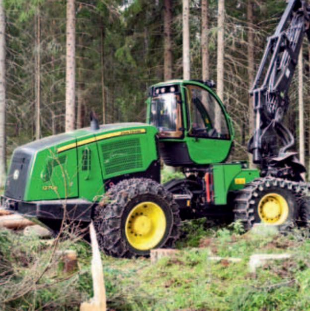
Abb. 3: Vergrößerte Motorhaube des John Deere 1270 E Harvesters mit Euro III B Motor.
