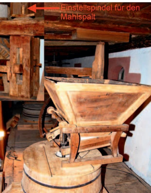
Abb. 14: Mahlgang mit Verkleidung und Rüttelstuhl mit Trichter und Einstellspindel (kleine Abbildung) für Getreidemühlen
