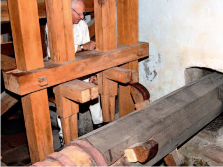
Abb. 16: Nockenwelle zum Antrieb von 4 Stößeln für ein Stampfwerk zum Zerkleinern von Ölsaaten in der Klostermühle in Seligenstadt
