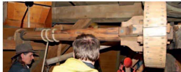
Abb. 20: Reibrad und Windenwelle des Sackaufzugs (Betätigung durch Hebel im Hintergrund) in der Holländer Windmühle im Freilichtmuseum Hessenpark; kleines Abbildung selbstschließende Durchgangstüren in den Stockwerksböden
