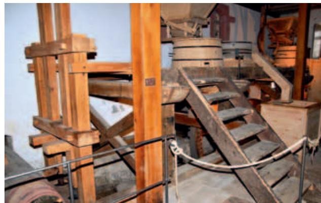
Abb. 12: Arbeitsplattform (Biet) mit Mahlgängen und unterliegender Kraftübertragung der Klostermühle in Seligenstadt; unten links Nockenwelle zum Antrieb der Stampfe der Ölmühle, nach hinten erkennt man die beiden Mahlgänge für Getreide
