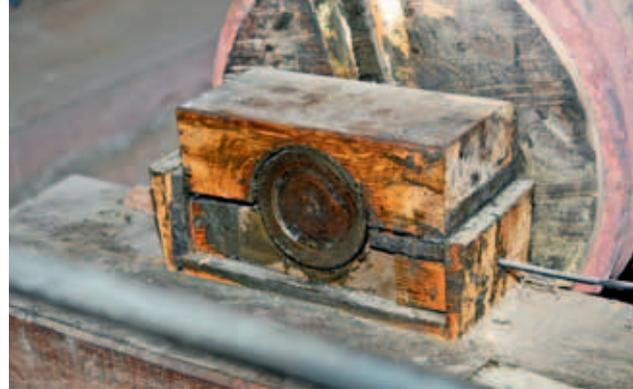
Abb. 9: Holzlager (Lagerschale aus Holz)
