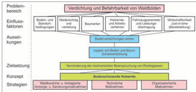
Abb. 1: Bodenverdichtung – Einflussfaktoren und Strategien zur Vermeidung
