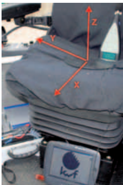
Abbildung 1: Schwingungsmessung: auf der Sitzfläche befinden sich der Sitzsensor und das Geräuschpegelmessgerät. Die drei Raumachsen, in denen gemessen wird, sind eingezeichnet. Unten ist die EDV-Ausstattung zu sehen. Foto: Peter Harbauer
