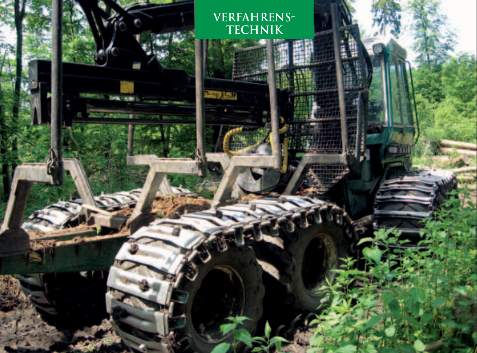
Abbildung 5: Leichttragschlepper Greemo mit 9 to Maschinengewicht, ausgerüstet mit Moorbändern (Eco baltic)
