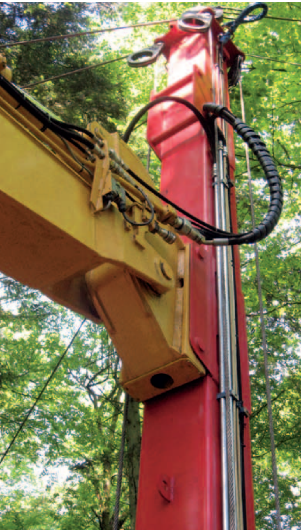
Abbildung 2: Der Kranturm kann an 2 Punkten am Baggerausleger befestigt werden.
