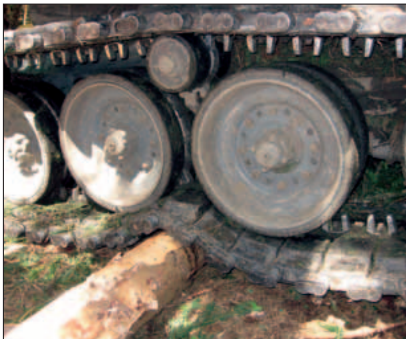
Abbildung 4: Besondere Laufwerkskonzeption: Doppelbogiejachse mit 2 pendelnd aufgehängten gummierten Doppelaufrollen je Laufwerksseite, die sich dem Mikrorelief zur Verminderung des Bodendruckes anpassen.
