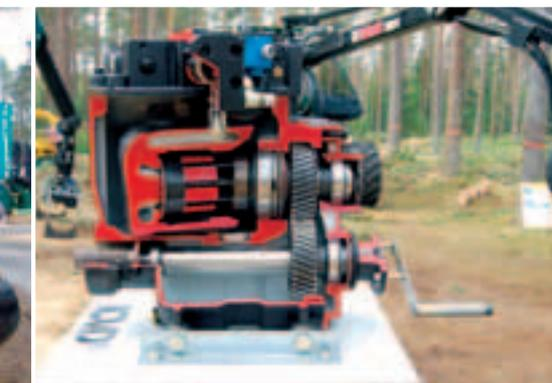
11 ICVD-Hydrostatmotor mit Weitwinkel-Ausschwenkung (Schnittmodell) bei HSM
