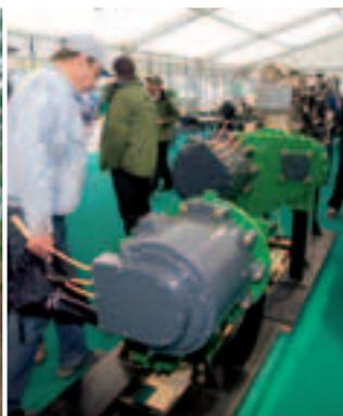
13 Dieselektrischer Antriebsstrang (Motor mit Anpassungsgetriebe und Generator sowie Radnabenmotor) von John Deere (Foto: John Deere)
