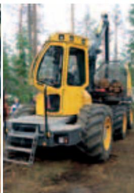
12 Forwarder EL-Forest mit diesel-elektrischem Hybridantrieb
