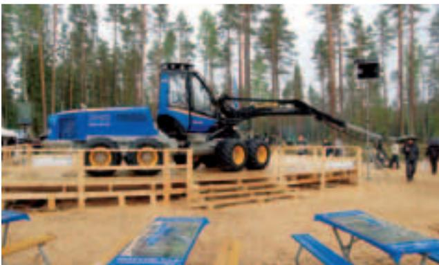
5 Prototyp 8-Rad-Harvester Rottne H 10
