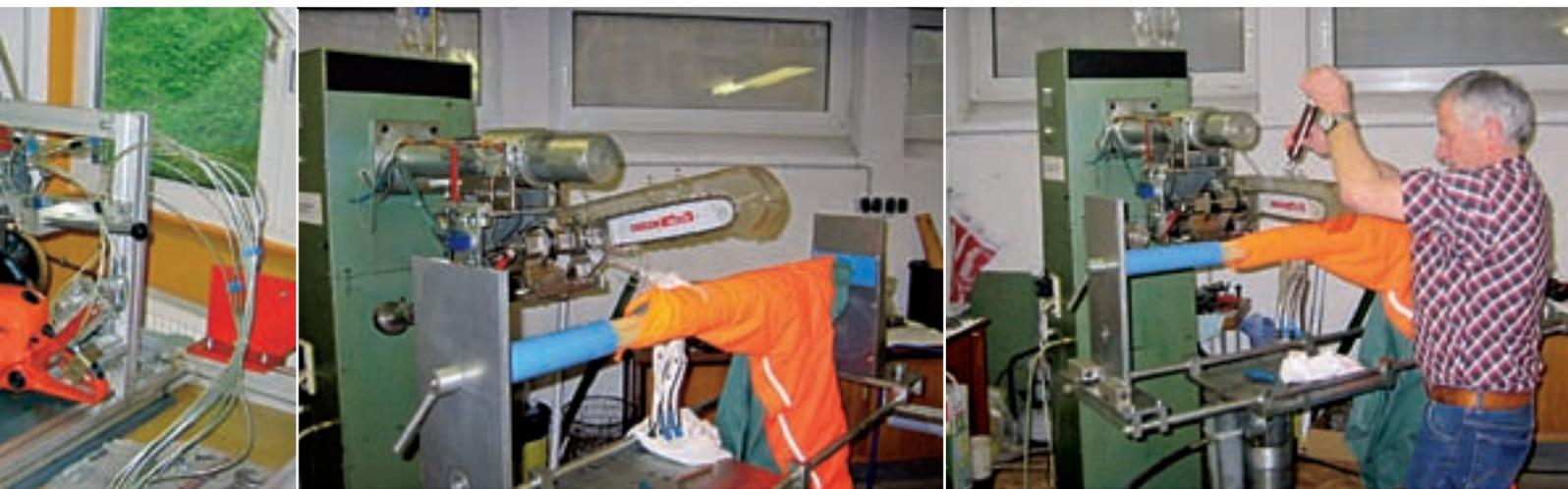
Fotos oben: Prüfstände für die Baumusterprüfung von Motorsägen und Schnittschutz
