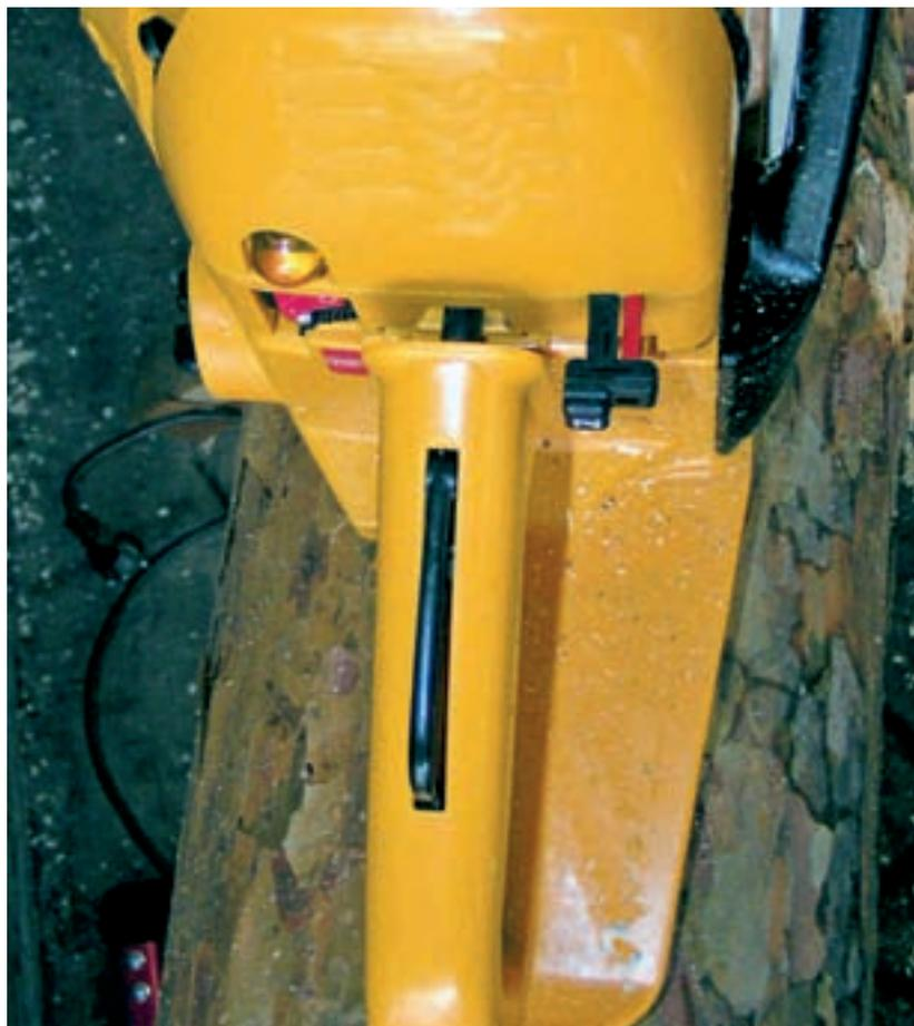
So ist es richtig: Gashebelsperre bei Betätigen des Choke-Schalters wirksam, nach abgeschlossenem Startvorgang keine kritische Drehzahlerhöhung möglich.
