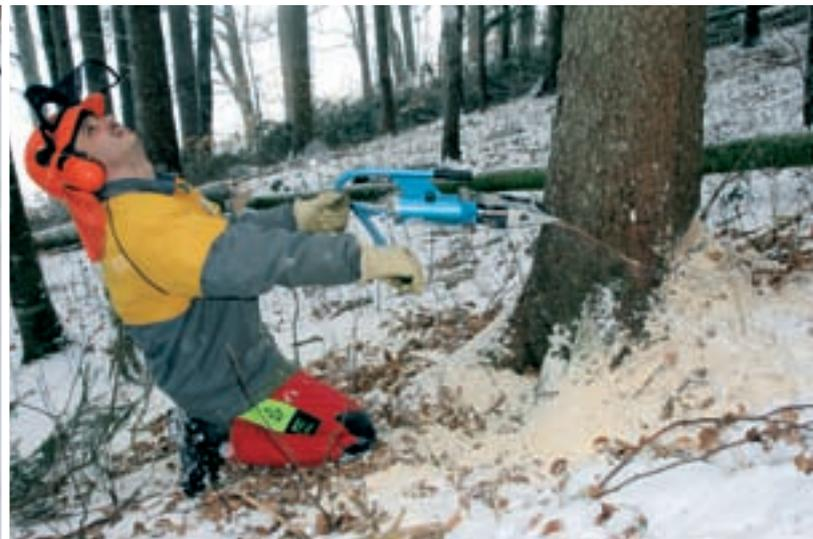
Das Arbeiten mit dem hydraulischen Fällkeil geht im Schwach- und Starkholz
