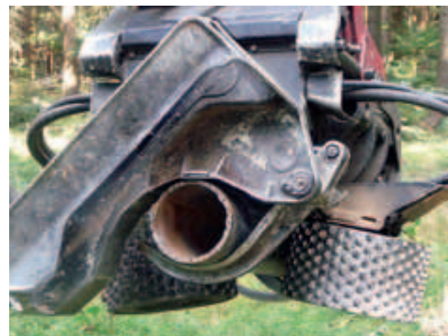
Abb. 2: Durchmessererfassung durch das Harvesteraggregat (Foto: Dietz)
