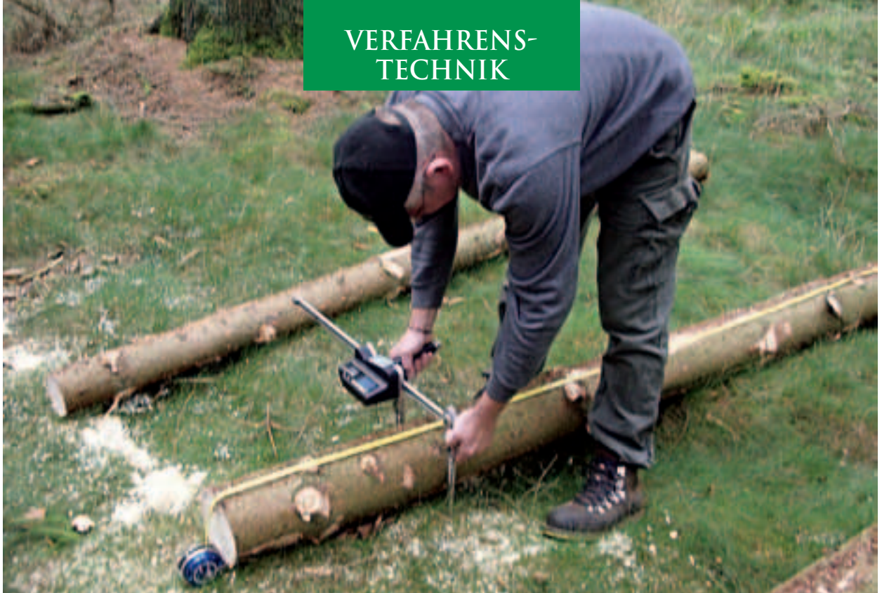
Abb. 3: Kontrollmessung mit Rollmessband und Digitalklupe (Foto: Urbanke)
