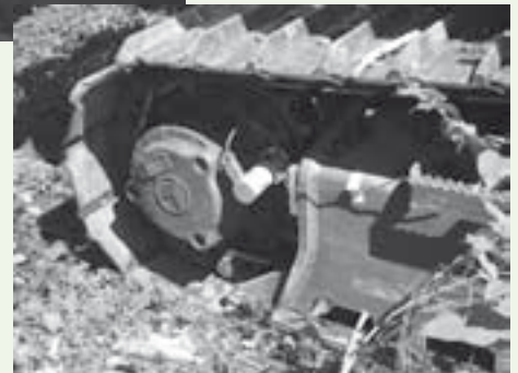
Abb. 5: Reibradsensor zur Messung des geometrischen Kettenvorschubs (theoretische Fahrstrecke)
