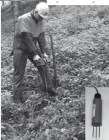
Abb. 2: Penetrologger zur Messung von Bodenfestigkeit und Feuchte im Oberboden; Details des Eindringkegels und der Feuchtesonde sind eingefügt; durch ein inte- griertes GPS-System wird der Messort festgehalten
