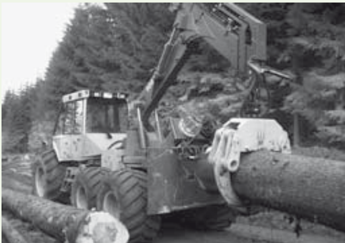
Abb. 2: Der HSM 904 Z-6WD ist mit einem sehr starken Rückekran ausgestattet, der mit einem Doppelteleskop 7,2 Meter in den Bestand hineingreifen kann und 220 kNm hebt. Dank eines hierauf abgestimmten, starken Schwenkwerks kann er Massen bis zu 5 Tonnen zügig und zugleich schonungsvoll vorrücken und rücken.
