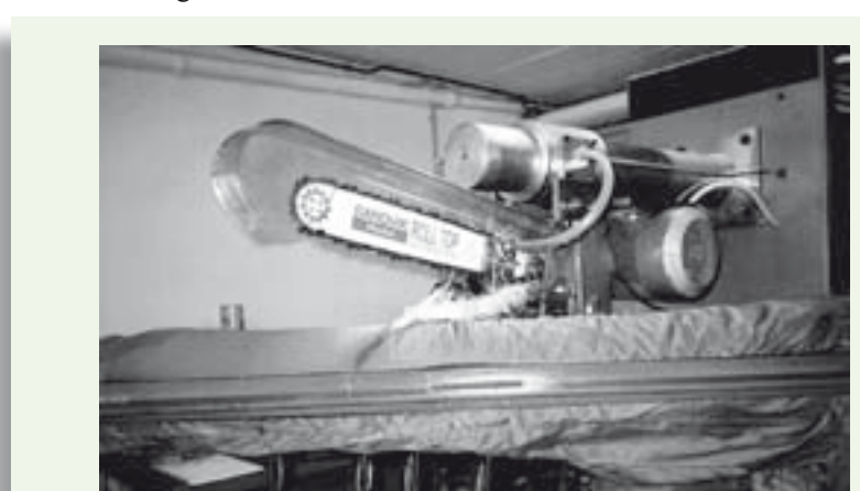
Abb. 3: Schnittschutzprüfung auf dem Prüfstand
