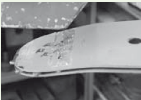
Abb. 2: Biegebeanspruchung im Umlenkbereich
