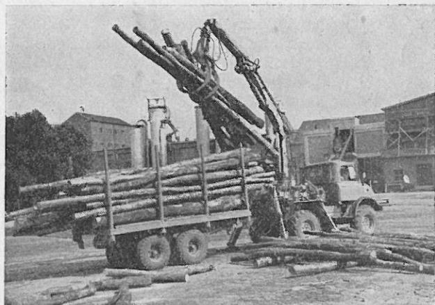
Abb. 2: Entladung des Rückezuges im Werk bei Direkttransport ab Rückegasse auf kurze Transportentfernungen. (Foto Grammel) (zu Seite 96)
