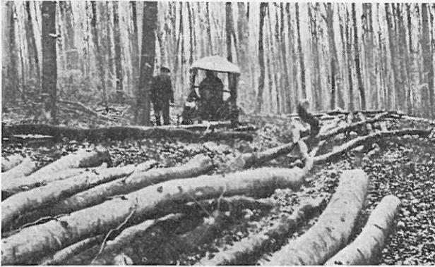
Abb. 9: Rücken von Industrieholz in Baum­längen aus einem Buchen-Durchforstungsbestand mit Kleinschlepper. (Foto Grammel)
