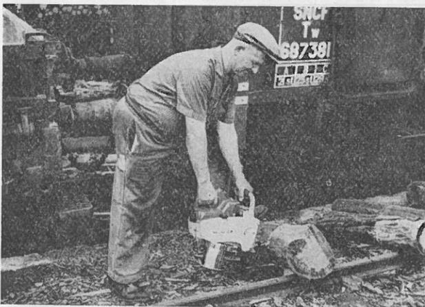
Abb. 13: Entnahme von Spanproben zur Feuchtigkeitsbestimmung aus Faserholzprügeln bei Gewichtsmessung. (Foto Jehle)
