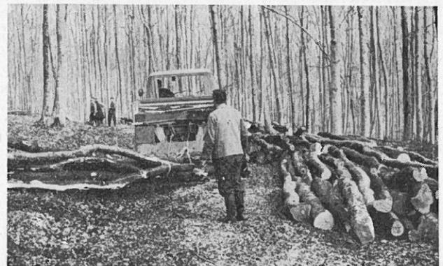
Abb. 8: Rücken von Industrieholz in Baumlängen aus einem Buchen-Durchforstungsbestand mit UNIMOG. (Foto Grammel)
