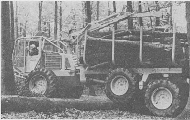
Abb. 4: Lokomo-Kranrückezug.
