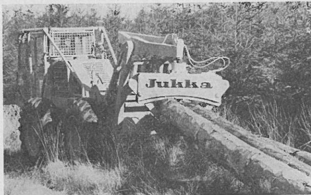
Abb. 3: Lokomo-Forstschlepper mit Doppeltrommelwinde und Jukka-Rückezange.
