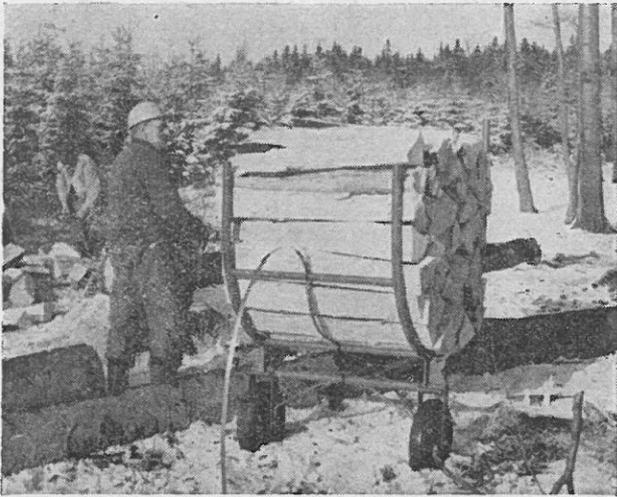
Abb. 4: Volleingelegter Bündelwagen vor dem Bandspannen.
