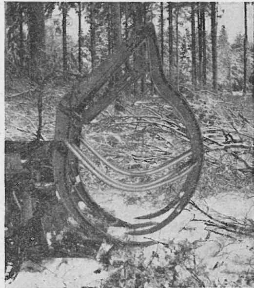
Abb. 6: Geschlossene Schichtholzrückezange.
