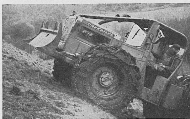
Abb. 2: Verwendung von Gleitschutzketten (hier RUD „Bison“ DH 69 G) auf schmierigem Boden
