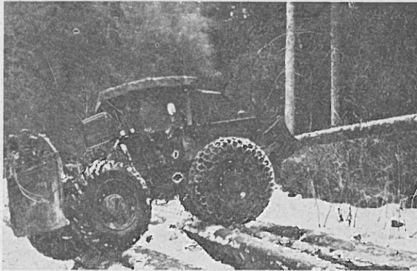
Abb. 10: Knickgesteuerter Forstspezialschlepper Welte ES „Junior“, 64 PS DIN.
