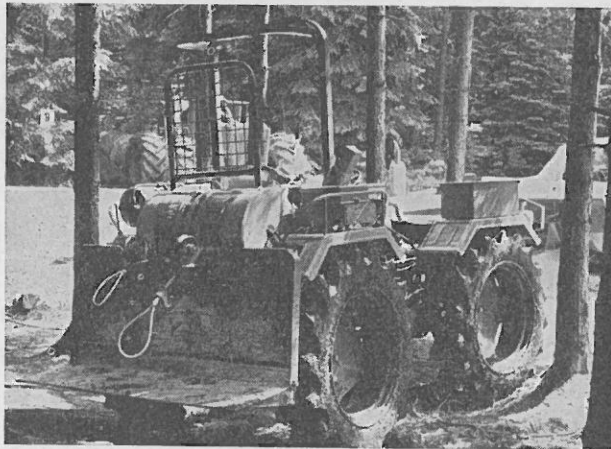
Abb. 4: Spezialschwachholzschlepper Carraro Tigrone 750, 45 DIN PS, in Ausrüstung mit Glogger-Doppeltrommelwinde und AEG-Telefunken-Funksteuerung.
