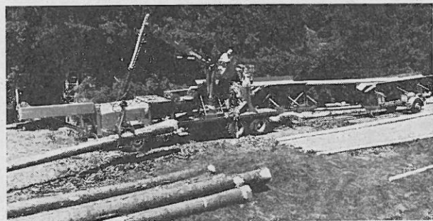
Abb. 9: Mobile Stammholzentbindungsmaschine der deutschen Kockum-Landsverk, für Holzlängen von 3–22 m und max. Durchmesser von 66 cm.
