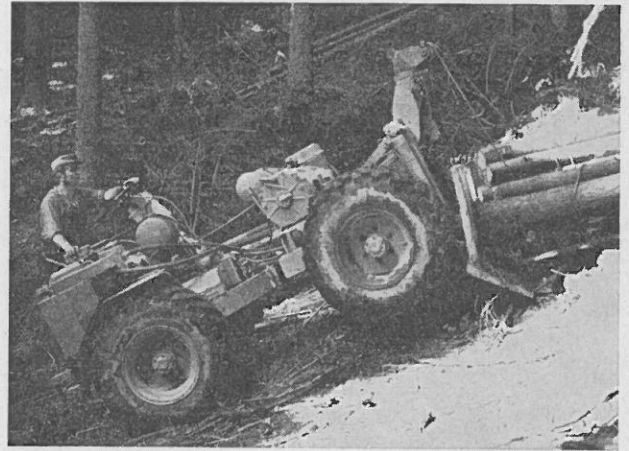
Abb. 5: Völker-Nagel-Rückemaschine aus knickgelenktem Fahrgestell eines Dumpers und elektro-pneumatisch gesteuerter, mechanisch angetriebener Glogger-Doppeltrommelwinde.
