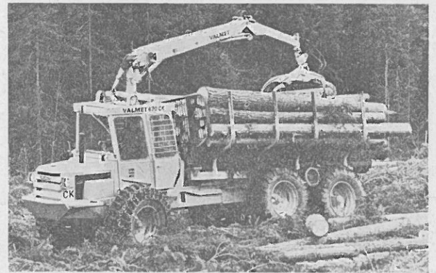
Abb. 1: Mittelschwerer finnischer Rückezug Valmet 870 ZK (88 SAE-PS) mit 3 m-to-Kran. Mechanischer Antrieb der vorderen Hinterachse, zusätzlicher Antrieb der hinteren Achse über Reibungsrollen.
