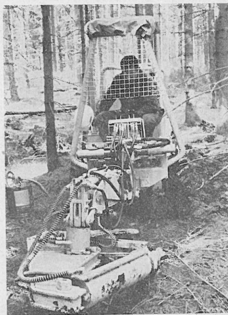
Abb. 2: Prototyp der hydraulischen Case-Fällschere, montiert auf knickgelenktes, allradgetriebenes Fahrgestell von nur 145 cm Breite. Dimensionen von Schere und Trägerfahrzeug stehen noch in einem Mißverhältnis.
