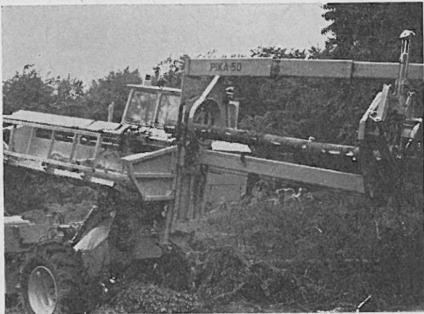
Abb. 8: Pika 50, Entastungs- und Einschneidemaschine der Firma Valmet bei der Arbeit. Maschine ist auf das Fahrgestell eines Knickschleppers montiert. Greifer und Entastungsmesser auf beweglichen Auslegern angebracht. Einschneiden in 2–6 m-Stücke durch „Fällbeil“.
