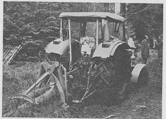
Abb. 6: Eicher-Mammut-Schlepper, 65 PS DIN, mit im Dreipunktgestänge untergebrachter, vollhydraulisch betätigter Kuxmann-Rückesäge, Typ Stammhalter.
