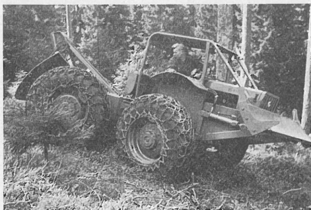
Abb. 3: Auch bei einer durchkonstruierten Maschine muß man die Bedienungsanweisung und die Unfallverhütung beachten und den Arbeitsplatz (hier Fahrerhaus mit Bedienungshebeln) auf seine Zweckmäßigkeit prüfen (Bringungsspezielleschlepper mit Sturzbugel).
