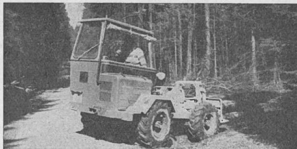
Abb. 1: Völker-Rückeschlepper AF 2030 mit Einmannkabine beim Rücken von Nadelschwachholz lang.
