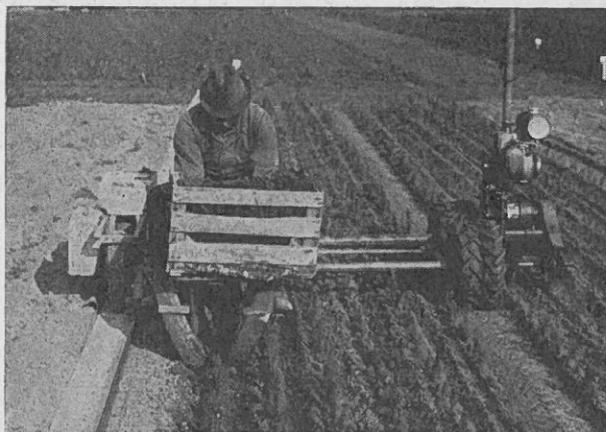
Abb. 3: Verschulen mit der Verschulmaschine HARI im Pflanzschulbetrieb
