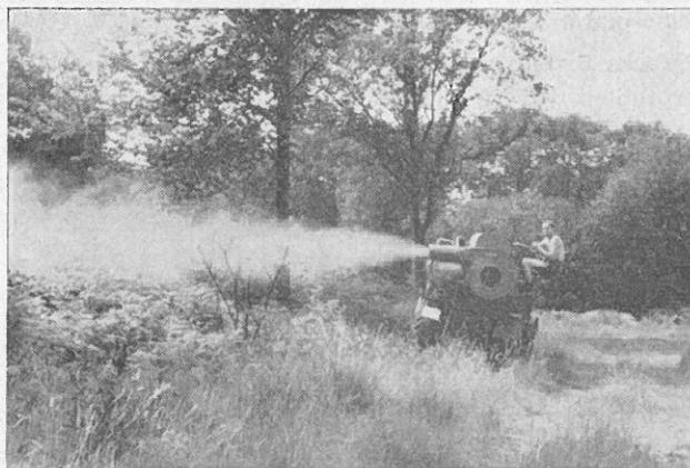
Abb. 6 Holder-TUK-Großsprühgerät bei der totalen Unkrautbekämpfung als Kulturvorbereitung. Der vorhandene Bestand wird abgetrieben, so daß evtl. Schäden durch Abtrift keine Bedeutung haben.
