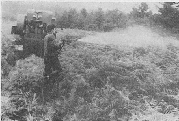
Abb. 5 „Gunjet-Spritzpistole“ zur Vermeidung von Abtriftschäden an der angrenzenden Fichtendickung. Hier angeschlossen an Holder-TUK-Großsprühgerät auf Unimog.
