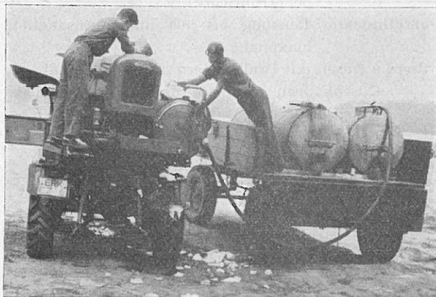
Abb. 7 Gut organisierte Wasserzufuhr. Das Anhängerfahrzeug wird beim Umsetzen des Gerätes jeweils mitgenommen. Die Füllung des Gerätefasses erfolgt über Injektor.
