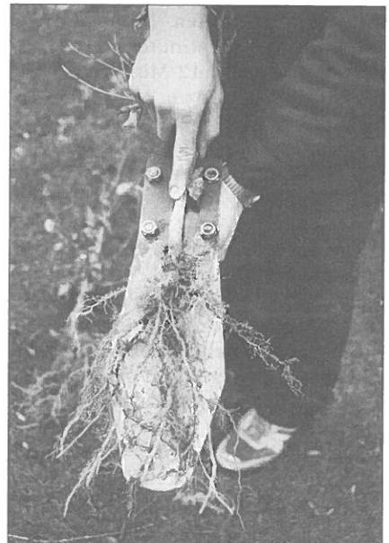
Abb. 1: Alles was mit der Hauptwurzel auf's Blatt paßt, kann mit der Hartmannhaue gepflanzt werden!
