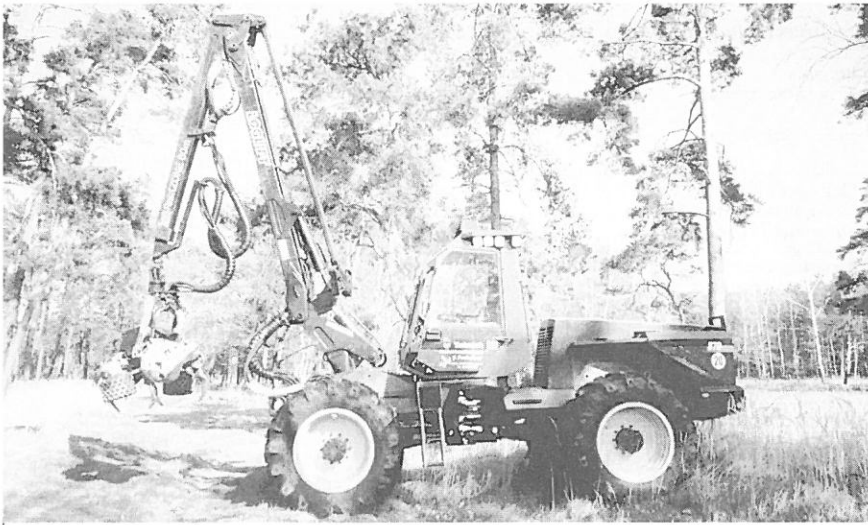
Trotz der vier Räder hat der Kranvollerter Timberjack 870 durch die hydraulisch gesteuerten Pendelachsen (Hevo-System) eine gute Standfestigkeit.
