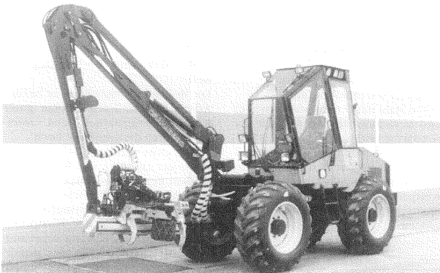
Mit einer Auslegerreichweite von nur 5,3 m sind gegenüber großen Vollerntern besondere Verfahrensvarianten erforderlich.
