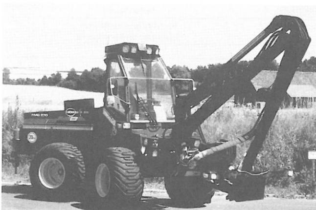
Die FPA/GS-Prüfung des Klein-Kranvollernters FMG Timberjack 0570 ist abgeschlossen. Mit einer Auslegerreichweite von nur 5,3 m sind gegenüber den drei anderen Vollerntern besondere Verfahrensvarianten erforderlich.
