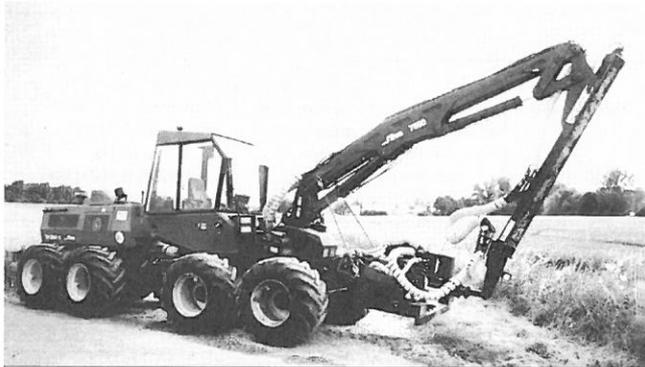
Kran-Vollernter Silva 854 TH kann hinsichtlich Grössenordnung zwischen FMG 0570 und Valmet 901 eingeordnet werden. Durch die niedrige Sitzposition ist die Sicht auch in Erstdurchforstungen und tief besteten Beständen gut.
