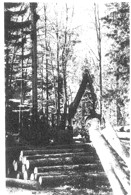
Die Vier-Seil-Anlage der Fa. MAYR MELNHOF mit Sortierkran
