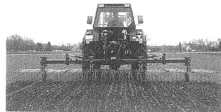
Abb. 1: Der Hackstriegel zur ganzflächigen mechanischen Unkrautbekämpfung
