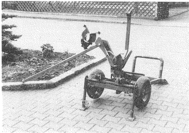
Abb. 3: Gerät zum Entasten mit dem Pferd
