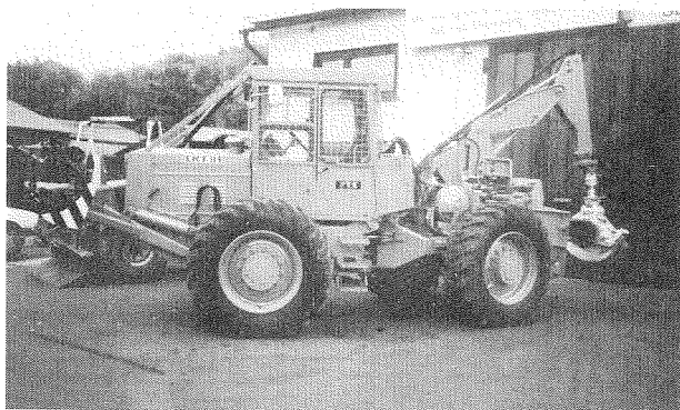
Abb. 4: Forstspezialschlepper mit Rückezange
