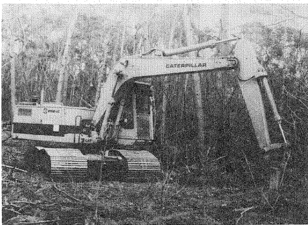
Abb. 1: Raupenbagger Caterpillar 215B mit Moorketten und Pflanzkeil
