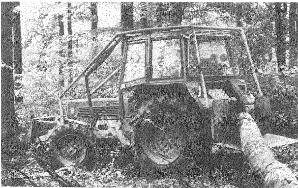
Abb.: Fendt Farmer 103 LS A mit kompletter Forstausrüstung, wie sie aufgrund der Erfahrungen im Forstamt Weilburg empfohlen wird. Foto: Heil
