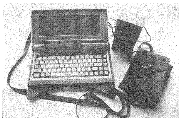
Abb. 1: TOSHIBA T1000 mit aufgeklapptem Display in Tragekonstruktion, externer Akku mit Tragetasche.
