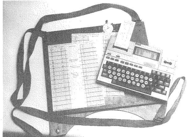
Abb.: Der EPSON HX-20 als universelles Zeitstudiengerät und vollwertiger PC (Schreibmaschinentastatur, vierzeiliges Display, Minidrucker und Mikrokassettenlaufwerk). Die programmierte Lösung „KONNEX“ (rechts) ist dem manuellen Verfahren (links) grundsätzlich funktionsgleich und analog.
