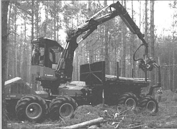
Der neue Valmet 801 Combi-Harvester (Foto: E. v. Bodelschwingh)
