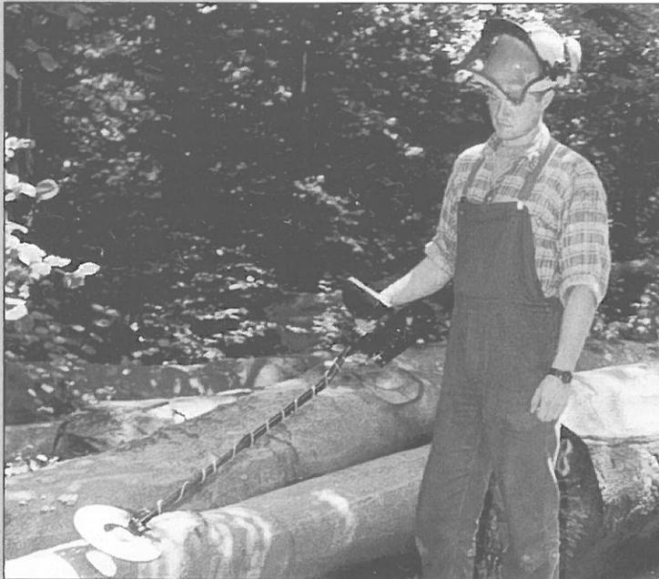
Spulening wird ein elektromagnetisches Wechselfeld erzeugt. Störungen durch metallische Stoffe werden erfasst und je nach Typ in optische oder akustische Warnsignale umgewandelt. Diese Methode erlaubt es, dass selbst kleinste Metallteile geortet werden können.
