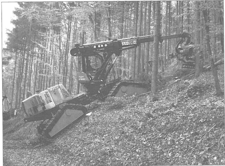
Über die **Produktivität der Maschine im Steilhangeinsatz** und die Leistung der anschließenden Holzrückung im Vergleich zu den bestehenden Alternativen referierte Karl Stampfer von der Universität für Bodenkultur in Wien. Die kurzfristig erreichte Produktivität des Harvesters sinkt bei einem Stückvolumen von 0,5 Fm mit der Zunahme der Hangneigung von 25 auf 65 % von etwa 25 auf 23 Fm/Std. ab, bei einem Stückvolumen von einem Festmeter von 31 auf 28 Fm/Std. Deutlich spürbar ist
