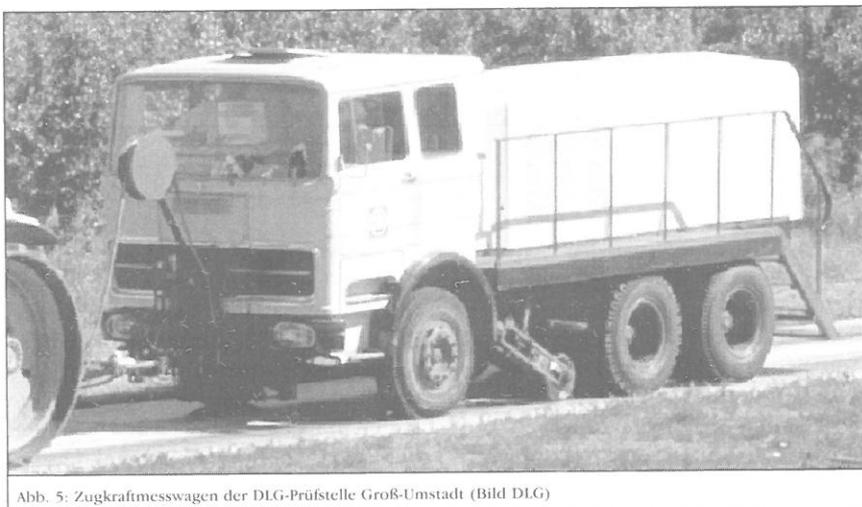
Abb. 5: Zugkraftmesswagen der DLG-Prüfstelle Groß-Umstadt (Bild DLG)
