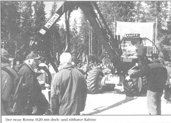
Der neue Rottne H20 mit dreh- und tiltbarer Kabine
