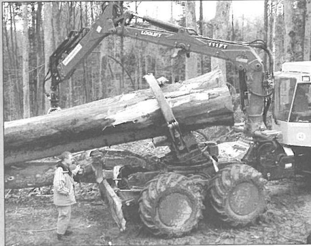
Kombinations-Trag-Seilschlepper vereinen die Konstruktionsmerkmale und auch die technische Ausstattung von Trag- und Seilschleppern. Sie sind bezüglich ihrer Fahrgestelle an die von Tragschleppern (6- oder 8-Radfahrgestelle) angelehnt, besitzen Ladekran, Rungenkorb, Doppeltrommelseilwinde mit heckseitigem Seilausgang, Rückeschild (meist höhenverstellbar, teilweise als Bergstütze nutzbar), Klemmbank.
