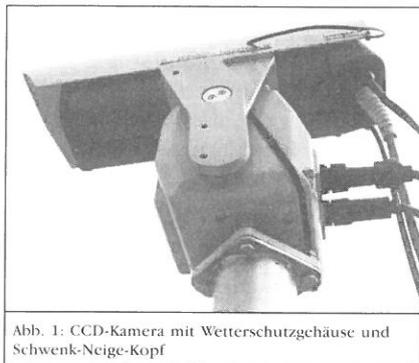
Abb. 1: CCD-Kamera mit Wetterschutzgehäuse und Schwenk-Neige-Kopf
