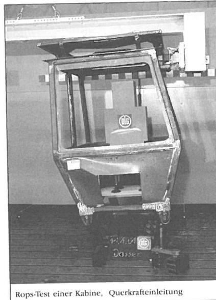
Rops-Test einer Kabine, Querkrafteinleitung
