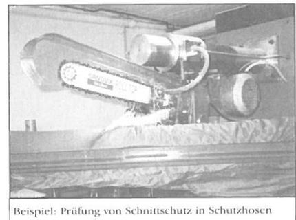
Beispiel: Prüfung von Schnitzzchutz in Schutzhosen
