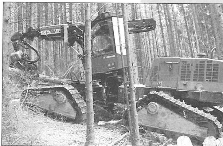
Durch die pendelt aufgehängten Raupenfahrwerke werden Effekte analog zu den Boogieachsen erreicht. Auch im stark kupperten Gelände bringt die Maschine dadurch ihre vier Antriebseinheiten auf den Boden. Gegenüber den starr mit der Maschine verbundenen Gleiskettenfahrwerken der Raupenharvester, neigt die Maschine auch bei Reliefwechseln (steil – eben) des
