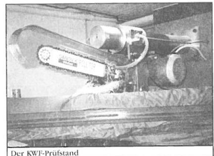
Bei 22 Schnitten kam es in sechs Fällen zu einer Durchtrennung. Die Mehrzahl der Schnitte durchtrennte die Einlage bis auf den Trägerstoff (= körpernächste Lage).
