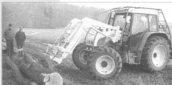
Abb. 1: Poltern, sicheres Aufnehmen, Halten und Ablegen der Stäbe durch den hydraulisch schwenkbaren Greiferzinken
