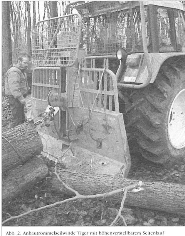
Abb. 2: Anbautrommelseilwinde Tiger mit höhenverstellbarem Seitenlauf
