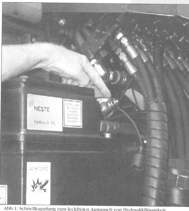
Abb.1: Schnellkupplung zum leckfreien Austausch von Hydraulikflüssigkeit
