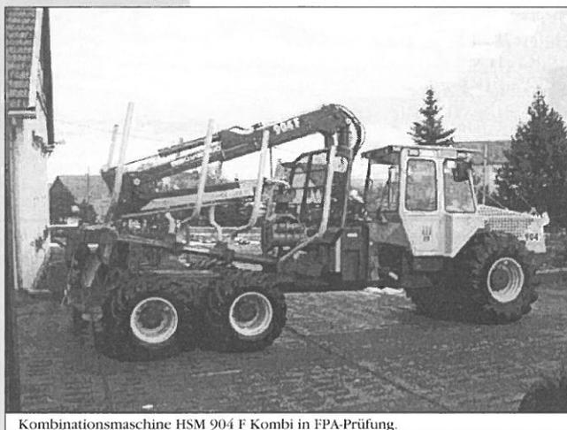
Kombinationsmaschine HSM 904 F Kombi in FPA-Prüfung.
